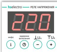
Если напряжение в сети не выходит за установленные пределы (180-250В по умолчанию), через 10 секунд прибор подключит нагрузку к сети, индикатор перестанет мигать. В дальнейшем, при любом повышении или понижении уровня напряжения сети устройство отключит нагрузку, индикатор в мигающем режиме будет индицировать уровень напряжения в сети. Нагрузка не будет подключена до тех пор, пока напряжение не нормализуется.
