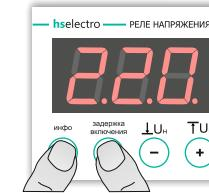
Устройство автоматически выйдет из режима калибровки через 10 секунд после последнего нажатия любой из кнопок.
