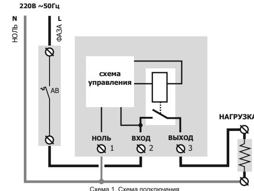
Суммарная мощность всех подключенных устройств не должна превышать максимальную мощность нагрузки прибора. Если мощности прибора недостаточно, необходимо использовать контактор.
