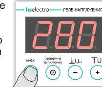
Устройство автоматически выйдет из режима программирования через 10 секунд после последнего нажатия любой из кнопок.
